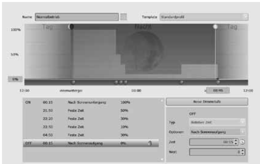
Bild: Bildschirmkopie der LED-Steuerung für «Normalbetrieb»
